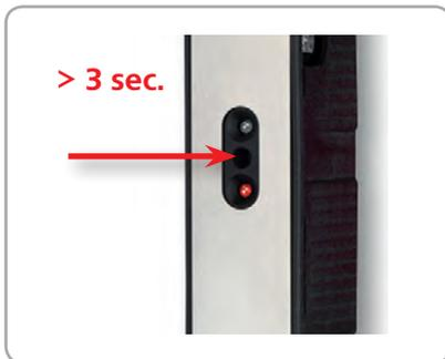
1. Betätigen Sie die Programmiertaste der Steuerung bzw. des Funkempfangsmoduls **solange (länger als 3 Sek.), bis die grüne LED (Steuerung) bzw. rote LED (Funkempfangsmodul) schnell blinkt**. Dann die Taste loslassen.
