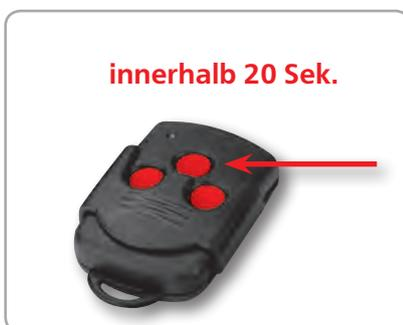
2. Betätigen Sie nun **innerhalb von 20 Sek.** die mittlere Taste des Masterschlüssels.
