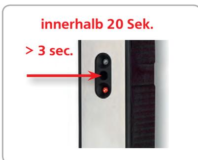
3. **Innerhalb von 20 Sek.** betätigen Sie nun die Programmiertaste der Steuerung bzw. des Funkempfangsmoduls erneut **länger als 3 Sek.** Bei Überschreitung des Zeitlimits von 20 Sek. wird der Löschvorgang abgebrochen.
