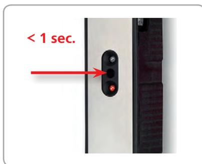
1. Betätigen Sie **kurz (max. 1 Sek.)** die Programmiertaste der Steuerung bzw. des Funkempfangsmoduls mit einem dünnen Gegenstand.
