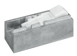
Mechanische Feststellung für Türen die zeitweise offen gehalten werden sollen Einfache Bestückung der Gleitschienenmodelle G-CO und G-GO-C Türfeststellung bis zu einem Öffnungswinkel von 130/110° Bandseite/Bandgegenseite Haltekraft stufenlos einstellbar Verwendung an Feuer- und Rauchschutztüren nicht zulässig
