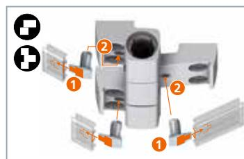
Zugbolzen in Abdeckstück schieben. Abdeckstück aufkleben. Kappen aufstecken.
