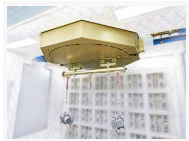
HELM Drehscheibe (Hub- und Senk Station)
